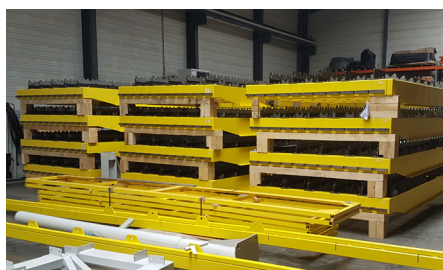
Réalisation de châssis mécanosoudés pour le BTP (chantier EPR anglais)
