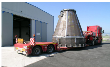
Fabrication d'un support de radar de navire militaire
